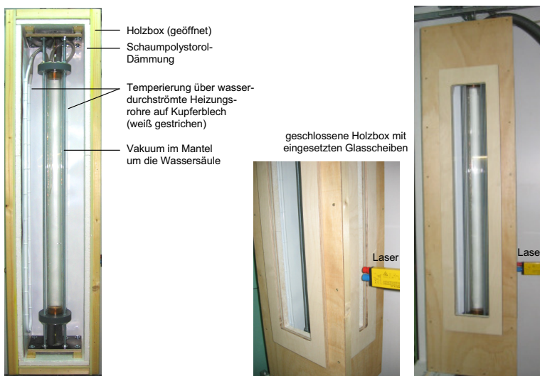
Abb. 5.5: Versuchssäule eingehaust in die zusätzliche Holzbox mit Temperierung (links) und geschlossene Holzbox mit eingelassenen Glasscheiben für Laser und Kamera (Mitte und rechts)
