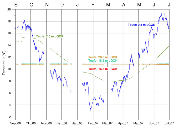
Abb. 2.10: Jahreszeitlich bedingte Temperaturschwankungen in der Luftsäule einer Überflur-Grundwassermessstelle (Die Messkette wurde aufgrund anderer Messungen mehrfach aus der Messstelle entfernt, wodurch Unstetigkeiten in den Messwerten entstanden.)
