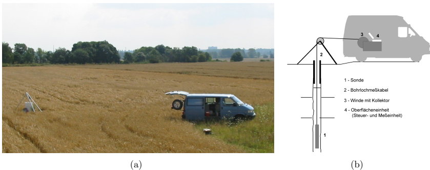
Abb. 7.1: Foto von einem Feldeinsatz (links) und Hauptbestandteile der Bohrlochmessanlage (entnommen aus Fricke und Schön (1999))(rechts)
